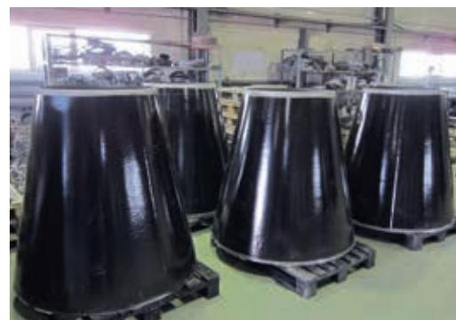
Втулки ООО «ЦЕЛЕР» с антикоррозионным покрытием, а также фасонные детали трубопроводов (отводы, переходы, тройники, фланцы) с антикоррозионным покрытием для соединений со втулками могут применяться как в нефте- и газодобывающей промышленности, так и в сфере ЖКХ на холодное и горячее водоснабжение, а также пищевой промышленности.
