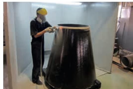
В качестве наружного покрытия для труб и деталей укладываемых в грунт мы используем полиуретановую краску «Protegol 32-60» (Германия). Покрытие наносится без грунта, имеет гладкую глянцевую поверхность и высокую стойкость к истиранию. Особо хотелось бы отметить, что данная марка покрытия – «Protegol 32-60», – является морозостойкой и при эксплуатации выдерживает температурный режим от – 60° до +80° С.
