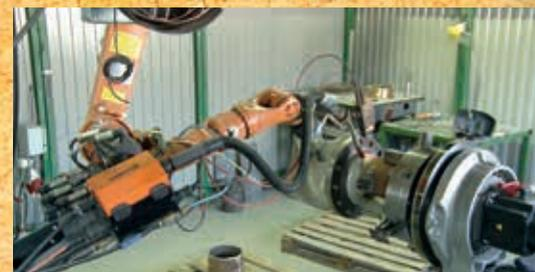
Нанесение антикоррозионных покрытий
